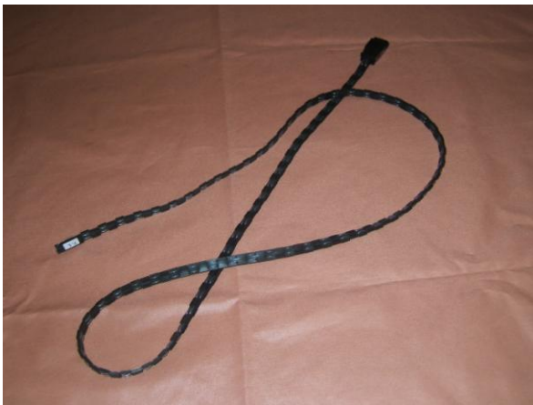
Photo 1: Capteur de pression – force à microcourbures périodiques sur support flexible
