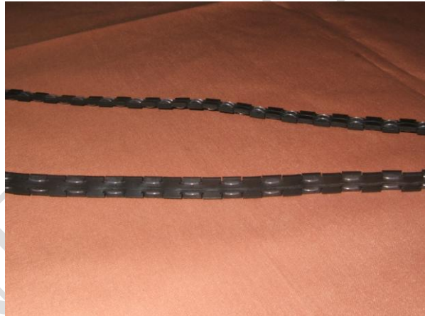
Photo 1: Capteur de pression – force à microcourbures périodiques sur support flexible
