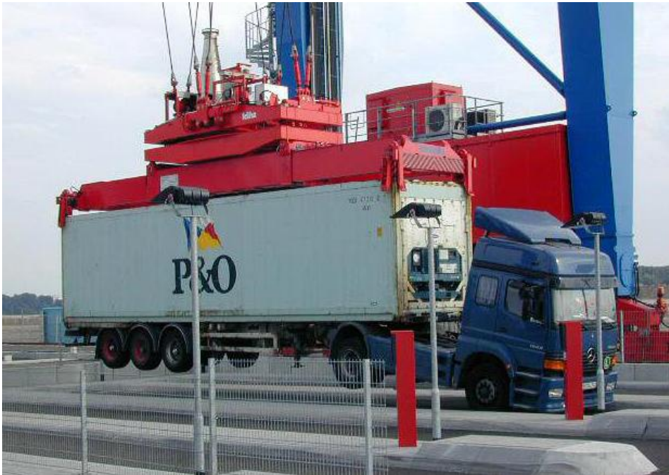
Camion soulevé par une grue suite à un mauvais déverrouillage du conteneur
